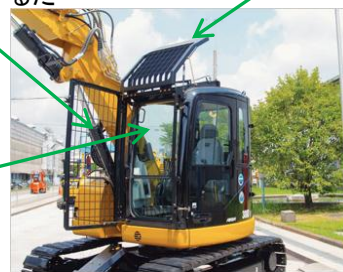
運転室周りの飛来物防護設備の例
